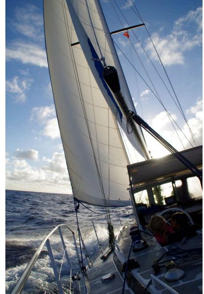
**Mast:** 16,50m mit zwei Salingen und Maststufen aus Aluminium, je drei Klampen an Stb. und Bb., zwei Fall-Stopper an Bb. zweigang 30er Winsch an Stb., zweigang 40er Harken-Winsch an Bb. Halterung für optionale dritte Winsch.
