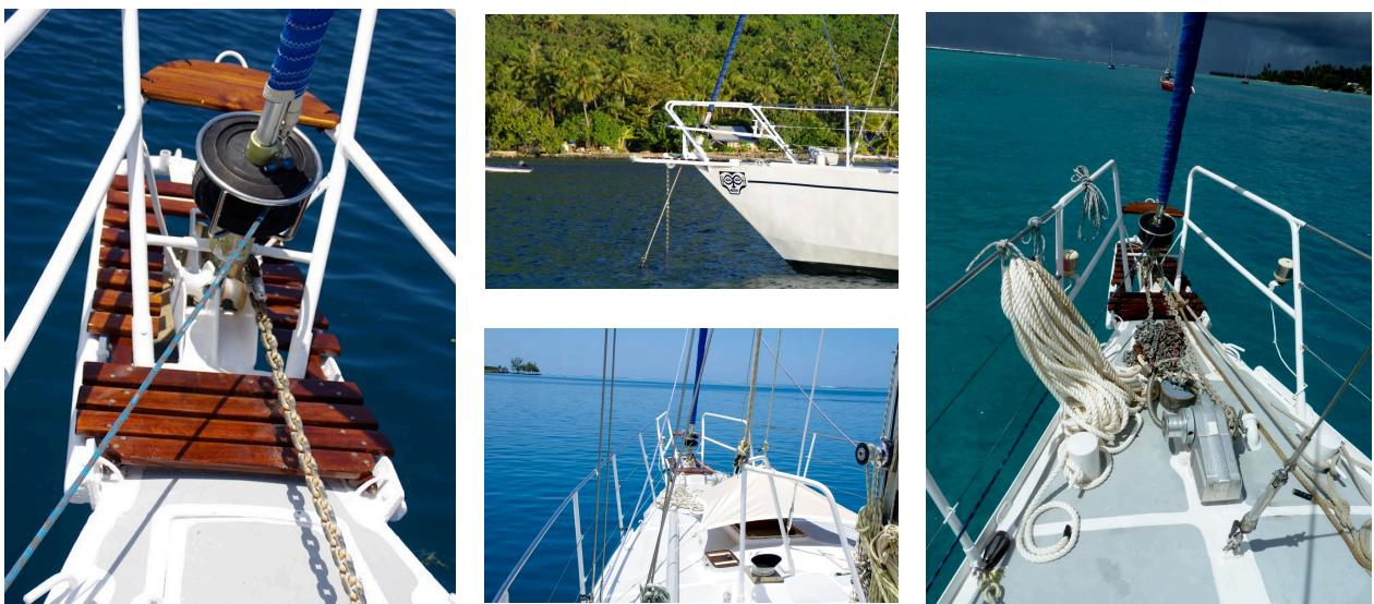
**Mittschiffs:** 10mm Babystag, zwei Unter- und zwei Oberwanten sowie zwei Backstage, wenn nicht in Benutzung. Die Reling ist mittschiffs beiderseits mittels Pelikan-Haken zu öffnen. Je zwei stabile Klampen auf beiden Seiten. Zwei Doradelüfter, die für Frischluft im Salon sorgen. Der Spibaum mit 4,20m Länge und 80mm Durchmesser ist üblicherweise an Backbord verstaut.
