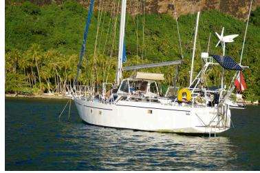
**Badeplattform:** Am Achterschiff angebracht befindet sich eine praktische Badeplattform mit ausklappbarer Badeleiter aus Niro. Des weiteren ist hier die Fleming Windsteuerung (komplett aus Niro) angebracht. Unter der Trittstufe befindet sich eine Rolle mit 200m Schwimmleine. Ein grosser 35kg Heckanker steht auf der Badeplattform an Stb.
